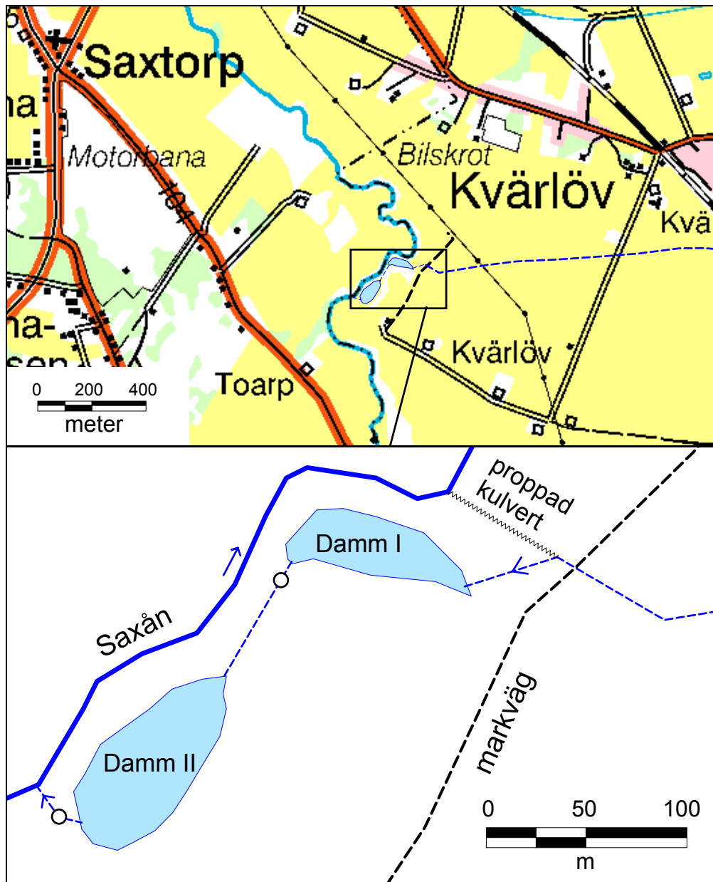
Figur 1. Översiktskarta och dammskiss. Dammarna är belägna i närheten av byn Kvärlöv, ca 10 km sydost om Landskrona. Vattnet till dammarna tas från en kulvert som avvattnar ca 150 ha, i huvudsak åkermark. Denna kulvert leddes tidigare direkt ut i Saxån. Efter passage genom de bägge dammarna leds vattnet ut i Saxån.
