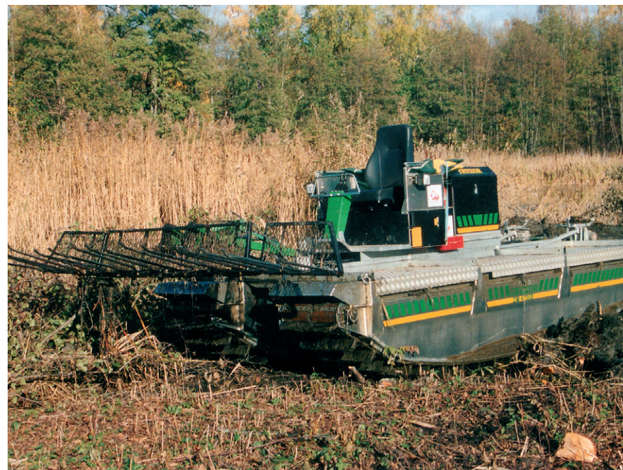
Amfibiegående klippmaskin av modell Truxor.
