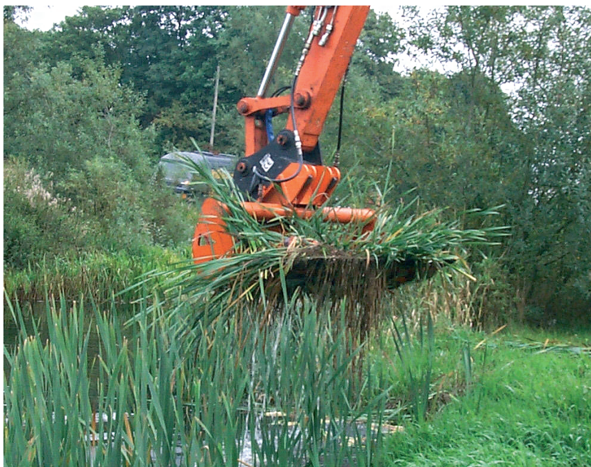
En klippskopa som består av en gallerskopa med en slätterbalkskonstruktion i fronten är lämplig vid klippning av vegetation i ett vattendrag.
