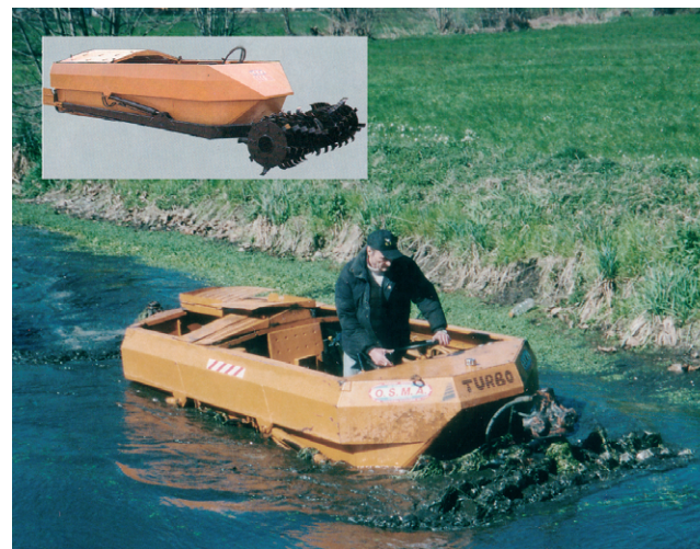
Fräsaggregat monterat på en mindre motorbåt för vegetationsbekämpning i kanaler och större diken.
