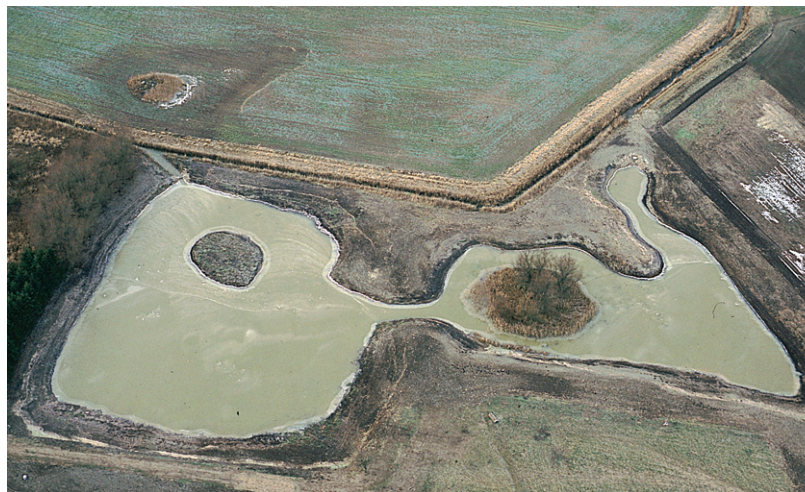
Denna damm vid Aggarp i Svedala kommun har anlagts som en sidodamm till Sjuspännesgropen i Segeåns vattensystem. Området har under 1800-talet utgjorts av våtmark. För att få bättre spridning på det inkommande vattnet i dammen har en ö placerats framför inloppet.
