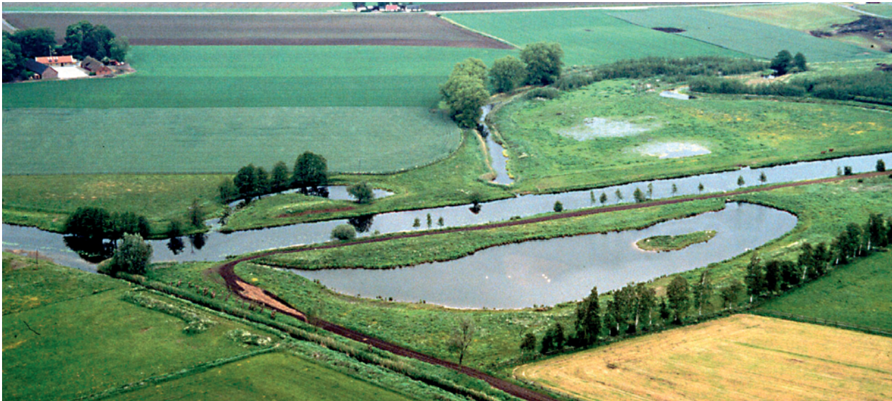
Denna damm intill Kävlingeån är exempel på en av flera dammar som har anlagts vid sidan av ån i Flyinge. På andra sidan den rätade ån syns en avskuren meanderslinga som rensats och åter fått förbindelse med ån via rör.
